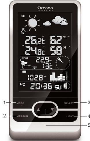
1. **MODE:** alternar entre los distintos modos de pantalla / ajustes; configuración del reloj; configuración de la altura; activar búsqueda automática
