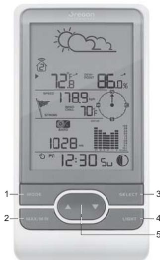
1. **MODE:** alternar entre los distintos modos de pantalla / ajustes; configuración del reloj; configuración de la altura; activar búsqueda automática
