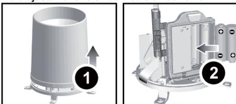
1. Retire los tornillos y deslice la cubierta hacia arriba para retirarla.
