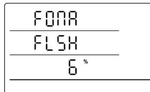
*Visualización del borrado de la memoria de datos de medición. En el ejemplo se ha borrado hasta el momento 6 % de los datos.*
