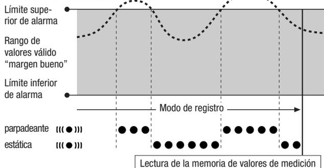
Además se puede configurar una histéresis para que la alarma se desconecte cuando el valor se encuentre dentro del margen válido.
