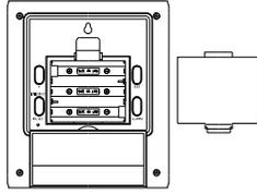
1. Retire la cubierta de las pilas que está en la parte trasera de la estación.
