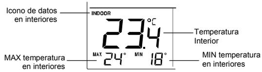
**Nota:** el rango de medición de la Temperatura MIN/MAX en interiores es -9°C a +38°C con una resolución de 1°C.
