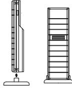
El transmisor viene suministrado con un soporte que puede ser instalado en una pared con la ayuda de los dos tornillos incluidos. El transmisor también puede ser colocado en cualquier superficie plana colocándole el soporte de montaje en la base, tal como lo muestra la figura.
