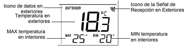
**Nota:** el rango de medición de la Temperatura MIN/MAX en interiores es -40°C a +60°C con una resolución de 1°C.
